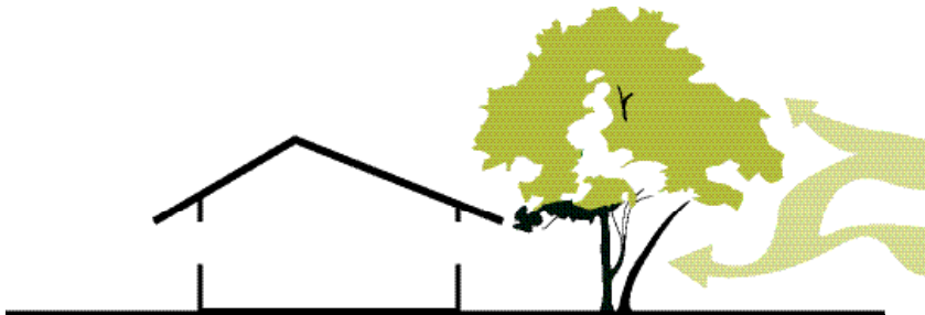
Figura 24 Árbol convenientemente ubicado y mantenido permite buena ventilación, sombreado y vista
