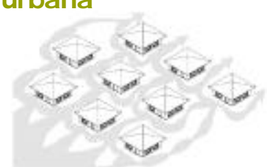
Figura 20 Buena ventilación independiente de la dirección del viento, en una disposición escalonada de las edificaciones
