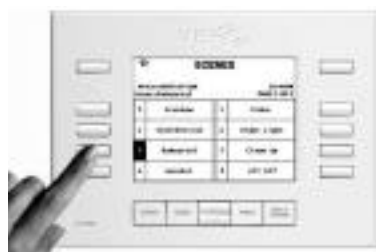
Figura 107 Sistemas automáticos para encendido y apagado de equipamientos
