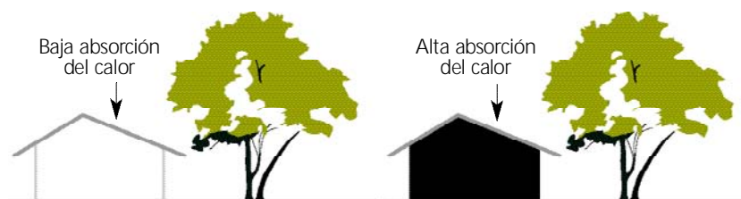
Figura 75 Los colores claros en paredes permiten rechazar parte del calor incidente
