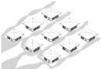
Figura 18 Ventilación pobre en una disposición lineal de las edificaciones, con caras paralelas a la dirección del viento
