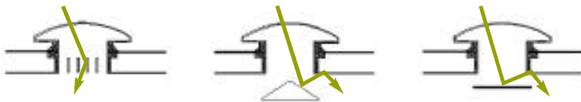
Figura 68 Opciones de cúpulas cenitales con difusores y espejos
