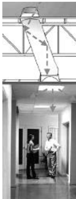
Figura 69 Ejemplo de iluminación natural a través de ductos
