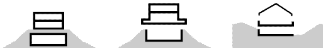
Figura 14 Diferentes soluciones para el aprovechamiento climático del suelo
