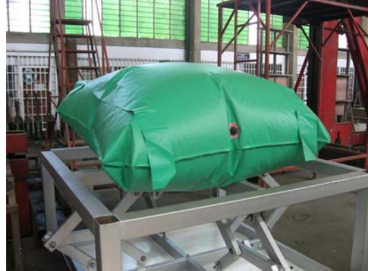
Figura 8 Mecanismo para mantener la horizontalidad del marco
