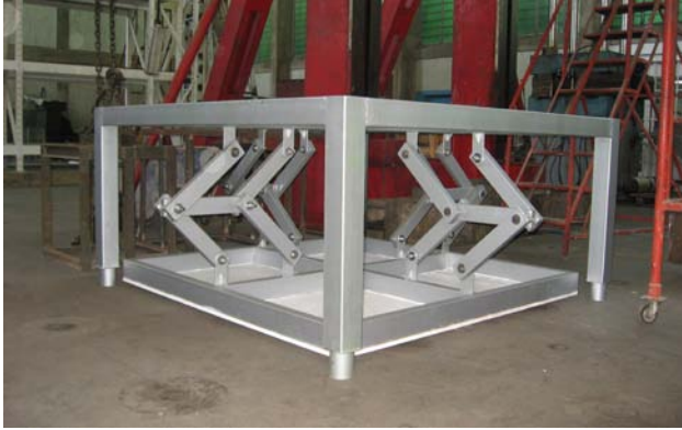
Figura 8 Mecanismo para mantener la horizontalidad del marco
