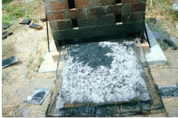
Figura 3: Ceniza de cascarilla de arroz a la salida del horno (Fuente: Elaboración propia)
